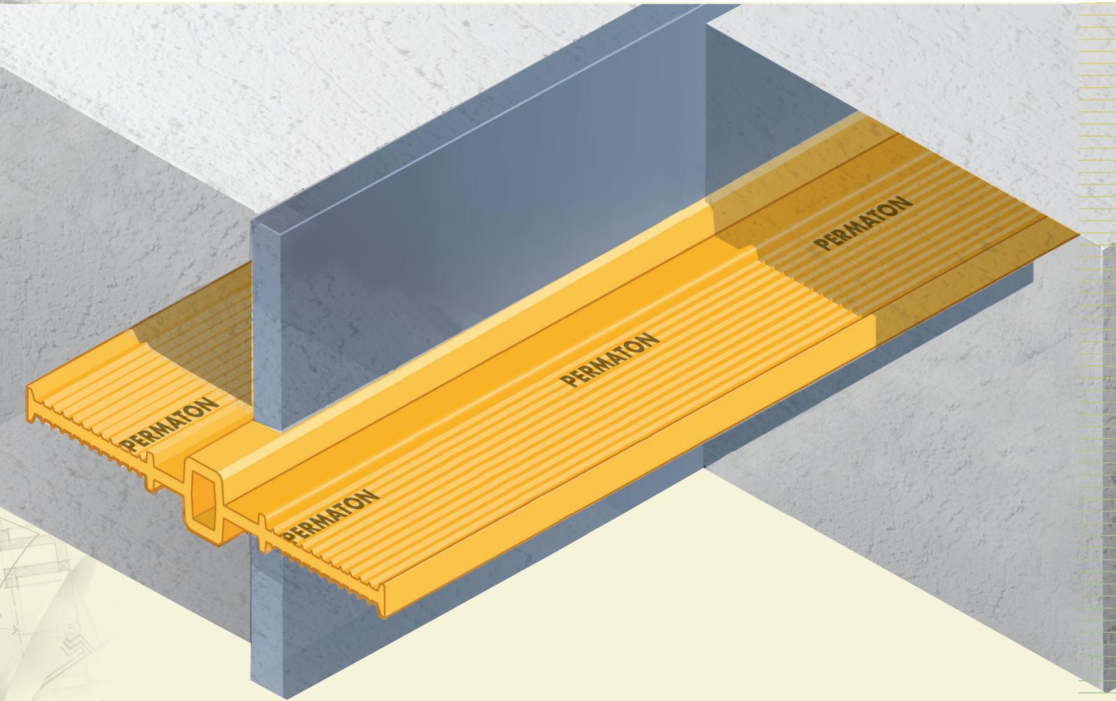
PERMATON®-Fugenbänder aus thermoplastischem Kunststoff (PVC-P) dienen der wasserundurchlässigen Abdichtung von Bewegungsfugen im Stahlbetonbau. PERMATON®-Fugenbänder gewährleisten eine sehr gute Verankerung im Beton sowie eine sichere Abdichtung gegen drückendes Wasser.
